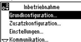
4. Wählen Sie das Untermenü "Grundkonfiguration". Wählen Sie den Anlagentyp/Grundtyp und die Position der Erweiterungsmodule
